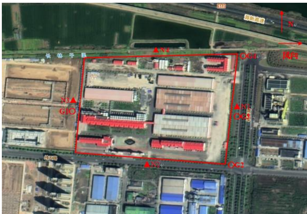
图 7.2-1 检测点位示意图（★废水检测点位；▲厂界噪声检测点位；○无组织废气检测点位）
